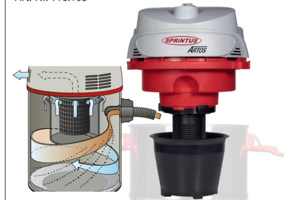
Durch den Drall am Einlassstutzen wird der Sprühnebel an der Behälterwand abgeschieden. Zusätzliche Filterstoffe sind nicht mehr notwendig. Die zuverlässige Schwimmerabschaltung reagiert selbst bei extremer Schaumbildung. Seitliche Kühl-Luftschlitze sorgen für konsequente Trennung von Kühl- und Prozessluft.
